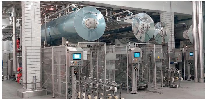
La gestion des énergies et de l'eau se fait au niveau des autoclaves mais elle peut être intégrée au niveau global de l'usine. Le système de récupération des eaux chaudes et froides permet de les recycler pour les cycles suivants et de mettre à disposition le
