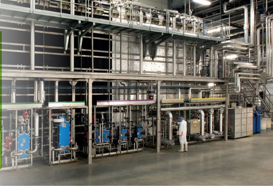
Unsere Systeme Continuous Hydrostatic Pasteurizer (CHP) und Continuous Hydrostatic Sterilizer (CHS) gliedern sich in drei Bereiche: den 1. Bereich für den Temperaturanstieg, den mittleren Bereich für die Wärmebehandlung und den 3. für die Kühlung. Jeder Bereich ist wiederum in mehrere Säulen gegliedert, in deren Innerem unabhängig\* vom Rest der Anlage spezifische Temperatur- und Druckwerte eingestellt werden können.
