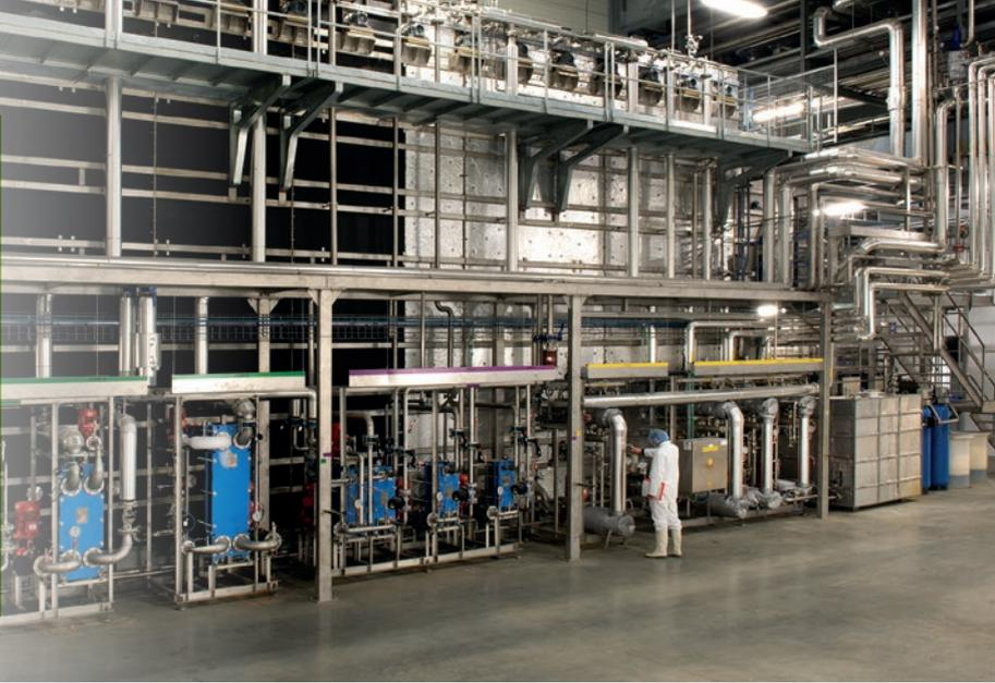
Nos systèmes Continuous Hydrostatic Pasteurizer (CHP) et Continuous Hydrostatic Sterilizer (CHS) se composent de 3 zones : la 1<sup>ère</sup> pour la montée en température, la zone centrale pour le traitement thermique, la 3<sup>ème</sup> zone pour le refroidissement. Chaque zone est elle même subdivisée en plusieurs colonnes, au sein desquelles il est possible de régler, de façon indépendante\*, une température et une pression spécifiques.
