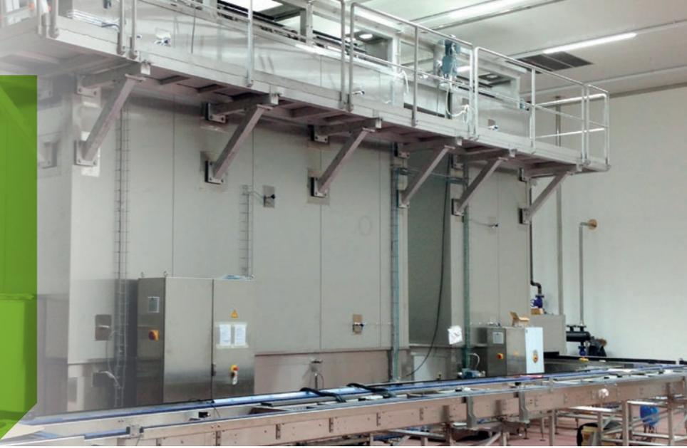
Der Continuous Modular Pasteurizer [CMP] dient zum kontinuierlichen und flexiblen Pasteurisieren Ihrer Produkte auf ebenen Bleche.
