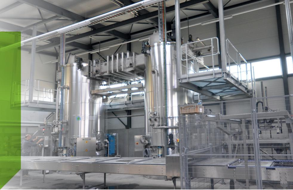
El Serial Tower es un sistema continuo de pasteurización/esterilización en el que sus productos están colocados en placas. Se compone como mínimo de 2 torres, una para calentar, la otra para enfriar, que las placas equipadas con productos van a cruzar. Durante ese recorrido, un sistema de pulverización de agua caliente, luego fría, va a garantizar un perfecto intercambio térmico mediante las boquillas repartidas, en cada nivel, entre las placas.
